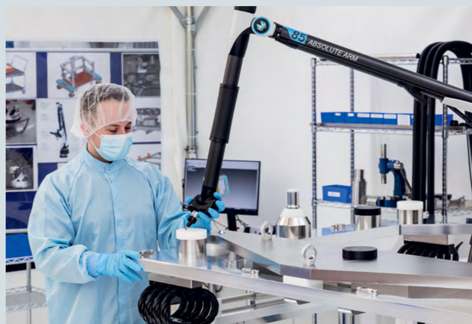
Controllo della qualità di un componente idoneo alla camera bianca da parte di RÖHM
