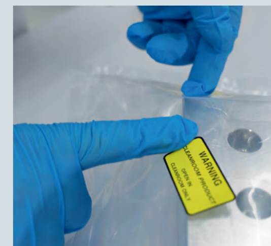
Empaquetado y sellado de un componente producido conforme a los requisitos para sala blanca de acero inoxidable
