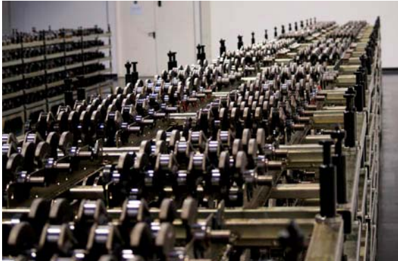
Bild Nr. 14-05 RM_FP-Versand.jpg Feuer Powertrain GmbH & Co. KG setzt auf Flexibilität und fertigt vollautomatisiert bis zu 1.800 Kurbelwellen täglich.
