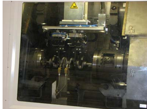
Bild Nr. 14-02 RM_FP-Beladen2.jpg Die Fertigung der Kurbelwellen läuft vollautomatisiert im Mehrschichtbetrieb ab. Über Ladeportale werden die Werkstücke von einer Maschine zur nächsten transportiert.
