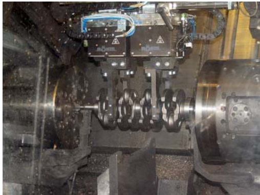
Bild Nr. 14-01 RM_FP-Beladen.jpg Feuer Powertrain in Nordhausen greift Kurbelwellen mit Greiferlösungen von RöhM.
