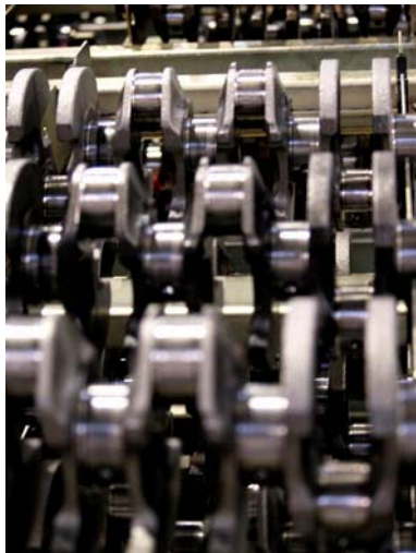
Bild Nr. 14-07 RM_FP-KW-Impression.jpg In der automatisierten Fertigung von Europas Marktführer Feuer Powertrain werden die Kurbelwellen mit Greifertechnologie von RöhM zwischen den Maschinen transportiert.
