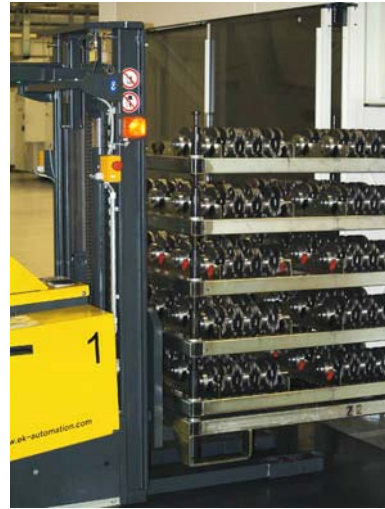
Bild Nr. 14-06 RM_FP-FTS.jpg Zwischen einzelnen Fertigungslinien gibt es Puffer mit Werkstückträgern auf Paletten, die von FTS übernommen und bereitgestellt werden.
