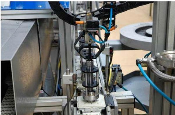
In gemeinsamen Gesprächen entstand die Lösung mit einem Kolben, der den Spanndorn zusätzlich aufspannt.
