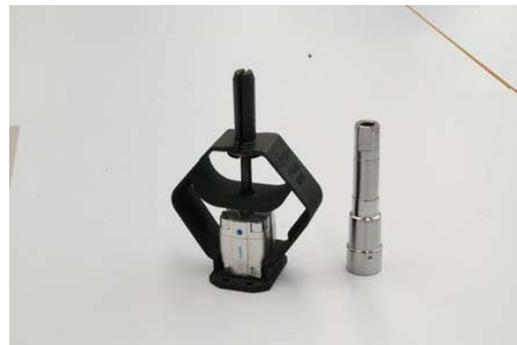
Der Greifer besteht aus einem gegen Kühlschmiermittel resistenten Kunststoff und wird im Lasersinterverfahren hergestellt.
