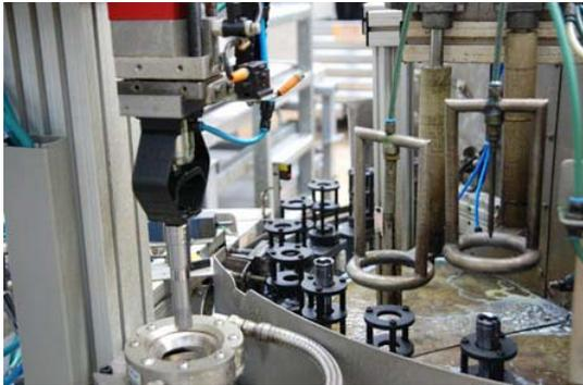
Das Teil wird sicher, kraftvoll und nahezu unverlierbar gehalten und kann hängend durch die Ringöse mit dem Lufttrom geführt werden.
