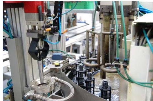
Zuverlässig und schnell packt der Röhm Kunststoffinnengreifer das Werkstück und führt es sicher durch die Ringöse.
