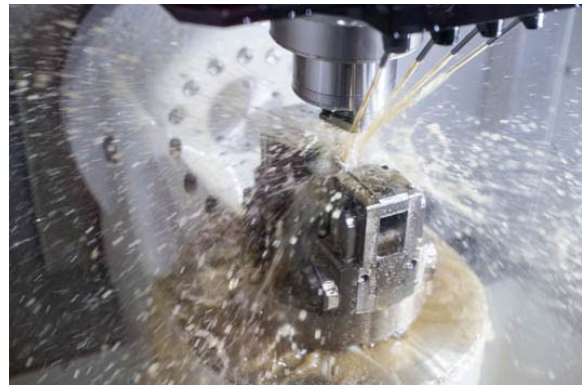
Bild Nr. 35-06 RM_IW-AufzugswelleBohrung.jpg IWC fertigt in einer einzigen Aufspannung alle notwendigen Operationen wie Fräsen, Bohren, Gewindeschneiden und Einstechen sowie die Feinbearbeitung der Kanten
