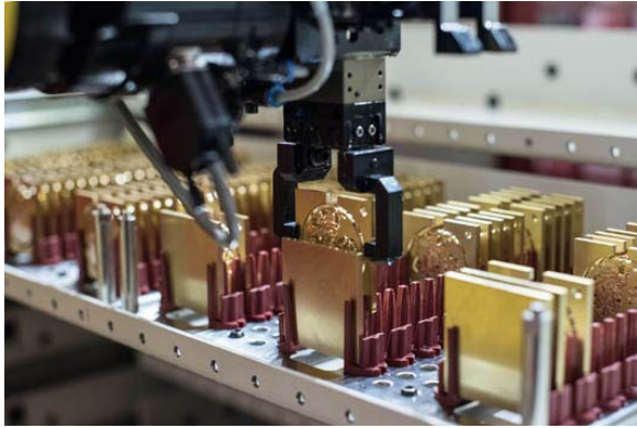
Bild Nr. 35-09 RM_IW-PlatineAblegen.jpg Bis zur fertigen Uhrenplatine werden bei einer Aufspannung 270 Operationen mit 54 Werkzeugen durchgeführt.
