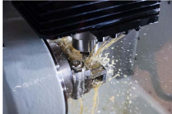
Bild Nr. 35-04 RM_IW-Fertigung.jpg Das preisgekrönte Kraftspann-Schwenkfutter von RöhM ermöglicht die Bearbeitung von drei Seiten bei einer Aufspannung.
