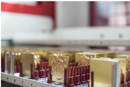
Bild Nr. 35-01 RM_IW-Platinen.jpg Die Fertigung der Uhrenplatine ist bei IWC die Geburtsstunde eines Manufakturkalibers.
