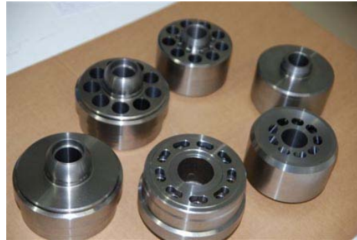
Bild Nr. 15-02 RM_MIK-Teile.jpg In einer Aufspannung fertig bearbeitete Teile für den Hydraulikantrieb in schweren Baumaschinen.
