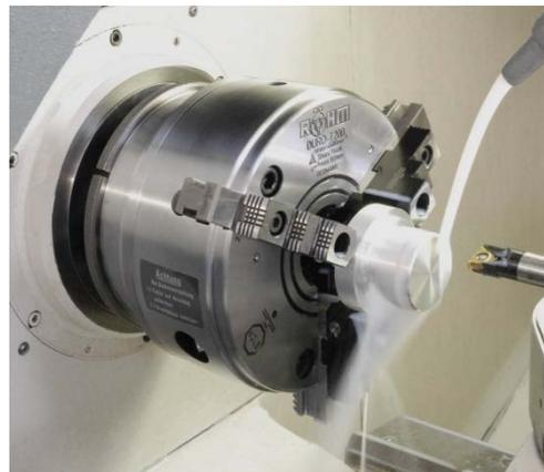
**Die Backen des Duro-T lassen sich einfach wenden, austauschen oder über den ganzen Spannbereich versetzen.**
