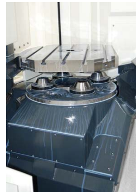
Bild Nr. 10-04 RM_DM-Spannkone3.jpg Der Palettenwechsel geht sehr schnell vonstatten. Nach dem Einschwenken der vorgerüsteten Palette wird die Werkstückpalette mit den Anzugsbolzen an der Unterseite auf die Aufnahmekegel der Spannköpfe aufgesetzt und zentriert.
