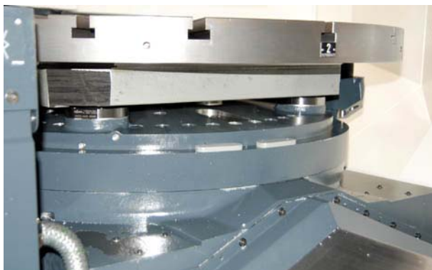
Bild Nr. 10-05 RM_DM-Zentrierung.jpg Die Palette wird immer horizontal und zentrisch positioniert. Das sorgt für guten Rund- und Planlauf von 0,01 mm und bis zu 0,015 mm.
