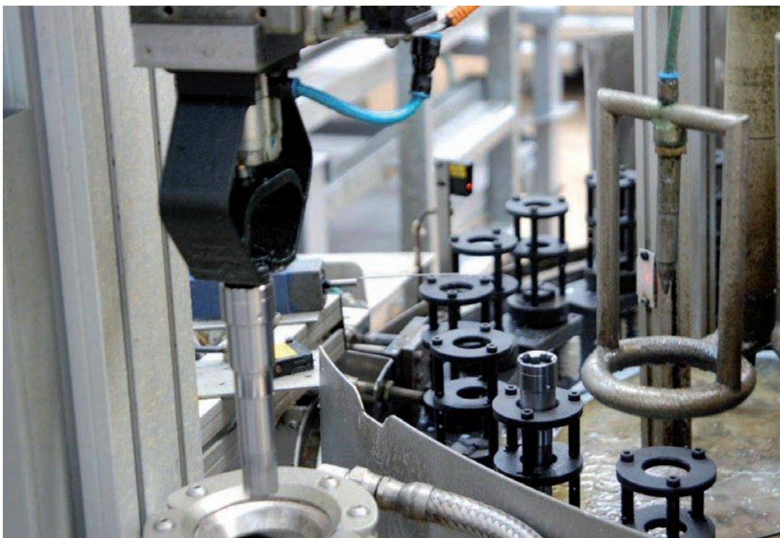
In gemeinsamen Gesprächen entstand die Lösung mit einem Kolben, der den Spanndorn zusätzlich aufspannt.
