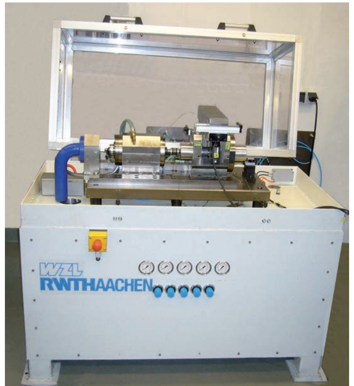
Der Prüfstand für Werkzeugspannsysteme bei RÖHM in Sontheim.
