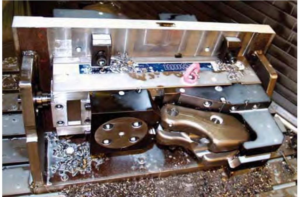
Für die Aufspannung entwickelte RÖHM zwei Spannvorrichtungen, die auf einem Aufspann-Winkelmodul angebracht werden. Die Sonderanfertigungen der formschlüssigen Spannbacken sitzen auf preisgünstigen Standardelementen.
