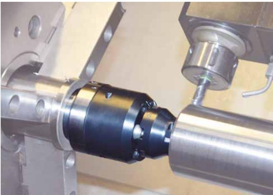
Fräsversuch auf einem Bearbeitungszentrum: Die RZ-Werte sind vergleichbar mit der Bearbeitung in einem Schraubstock.
