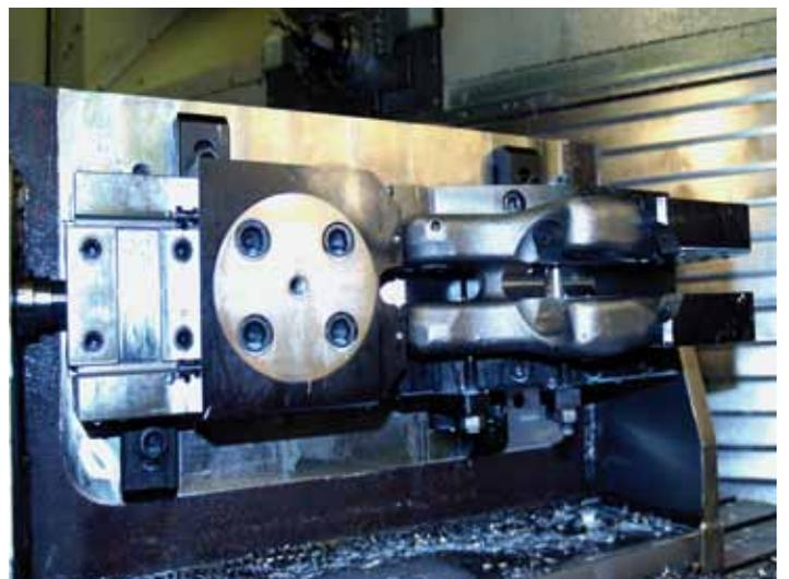
Bei der schwierigen Fertigung der Aufnahmetaschen bringt die Spannvorrichtung von RÖHM große Erleichterung. Die Seitenlage hat sich als ideale Lösung für die komplizierten Fräs- und Bohroperationen ergeben.
