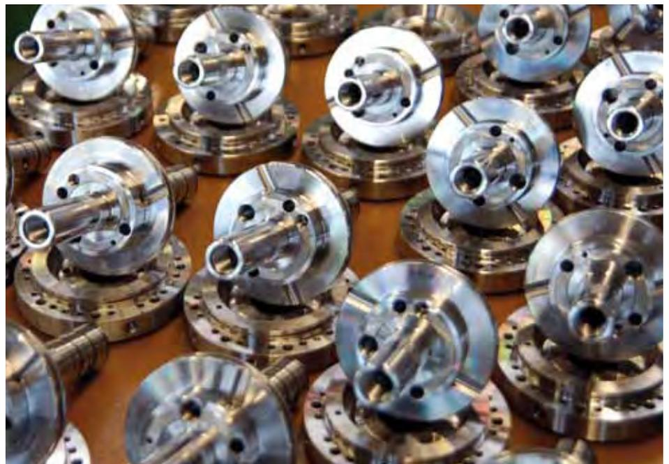
Als Systemlieferant bietet RÖHM natürlich auch entsprechende Spannzylinder für Kraftspannfutter. Im Bild zu sehen sind Spanncolben und Flansche für Vollspannzylinder.
