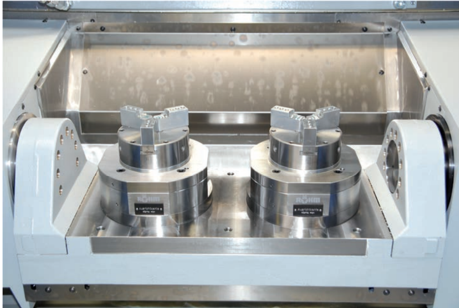
Pneumatisch betätigte PKF-Spanner von RÖHM sorgen für Flexibilität und Produktivität. Hauptzeitparalleles Beladen und Entnehmen von der ausgeschwenkten Tischseite.
