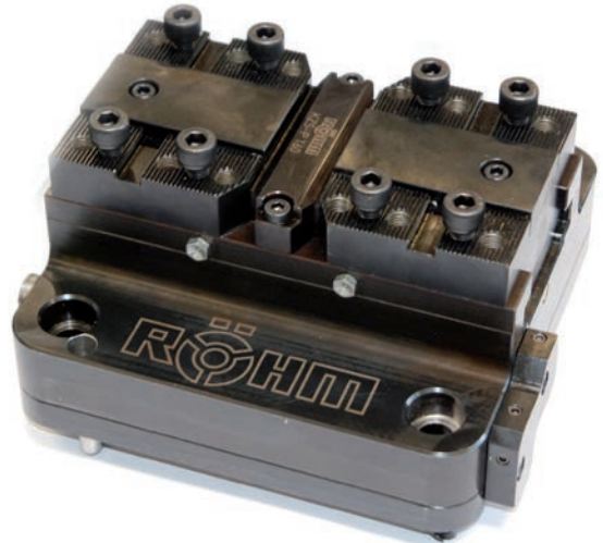
Die Grundbacken mit Spitzverzahnung und Kreuzversatzschnittstelle fahren einen Hub von 3,2 Millimetern und erlauben das Aufsetzen der bei Werder vorhandenen Spannbacken.
