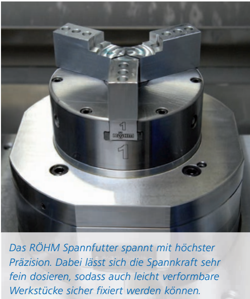
Die Grundbacken mit Spitzverzahnung und Kreuzversatzschnittstelle fahren einen Hub von 3,2 Millimetern und erlauben das Aufsetzen der bei Werder vorhandenen Spannbacken.
