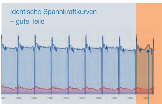
Jedes Werkstück hat seinen eigenen Fingerabdruck. Dieses Muster ermöglicht eine datengestützte Qualitätsprüfung. Ausreißer werden schnell identifiziert.
