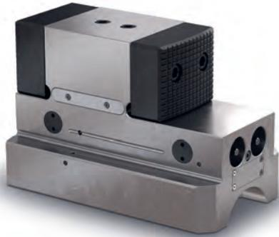
Mit den Echtzeitdaten der iJaw können Sie auf Planscheiben sehr große Werkstücke exakt ausrichten. Durch die Sichtbarmachung der Spannkkräfte auf jeder einzelnen Backe sehen Sie jede Spanndruckabweichung genau und können so korrigieren.
