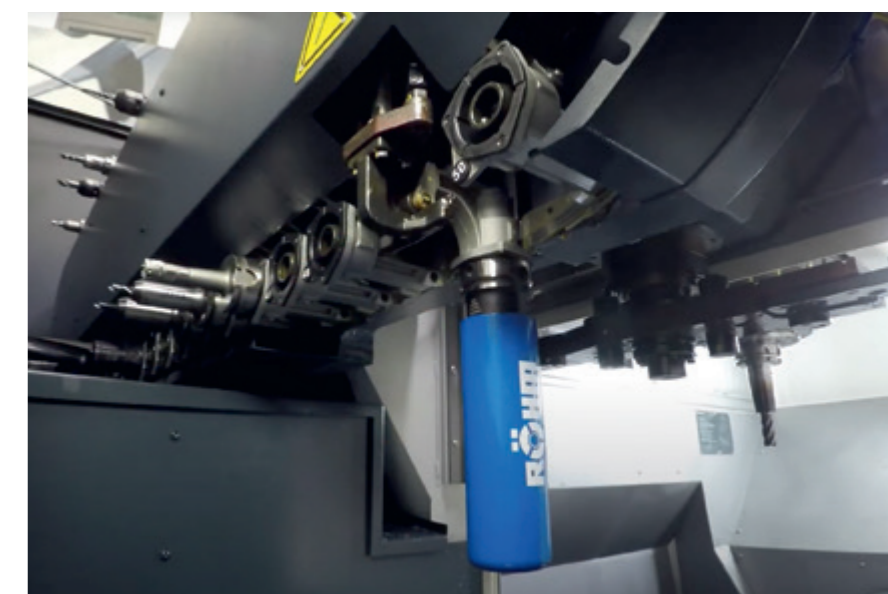
Lubritool在刀具库 中有其固定的位置，直接由加工程序定期调用
