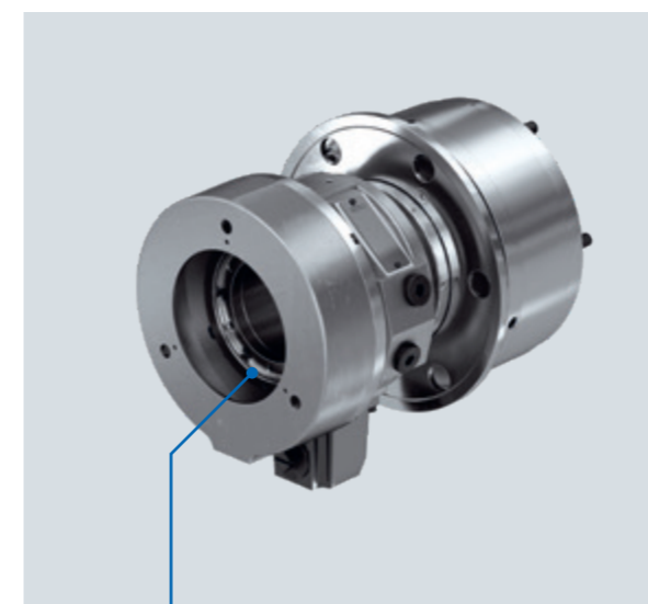
Na parte traseira, o Forto-HT oferece vários orifícios rosqueados no flange rotativo, que podem ser usados para conectar um batente longitudinal, um tubo guia de material ou uma união de passagem rotativa.
