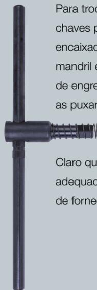
Para trocar as maxilas, estão disponíveis chaves para mandril adequadas. Elas são encaixadas em um dos três impulsos e o mandril é aberto até as maxilas deixarem de engrenar no anel espiral e ser possível as puxar para fora com a mão.
