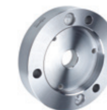
La flangia di alloggiamento con cono corto è disponibile per le dimensioni del cono 5, 6, 8, 11. Giunzioni nelle dimensioni ISO 702-1 (DIN55026, giunzioni), 701-2 (DIN55029, Camlock) e 702-3 (bulloni passanti con dado). Le flange sono adatte anche per il CoAE con utensile di centraggio.
