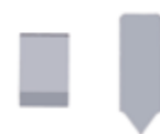
PIASTRE SOSTITUIBILI PER METALLI DURI per moto destrorso O sinistrorso (a sinistra), moto destrorso E sinistrorso (a destra).
