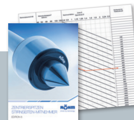
Les diagrammes de force de serrage permettent de déterminer facilement la bonne force axiale. Vous les trouverez dans le catalogue Röhm ou sur Internet à l'adresse www.roehm.biz .
