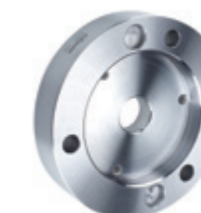
La bride pour le cylindre à cône court existe dans les tailles de cônes 5, 6, 8, 11. La liaison vissée existe dans les tailles ISO 702-1 (DIN55026, liaison vissée), 701-2 (DIN55029, Camlock) et 702-3 (Boulon à goujon avec écrou). La bride convient aussi sur le CoAE avec logement de centrage.
