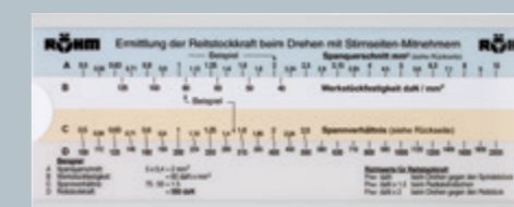
Avec la règle à calcul Röhm, il est encore plus facile de déterminer la force axiale.
