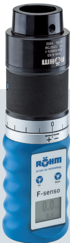
Medição da força de aperto com o F-Senso Spindle
