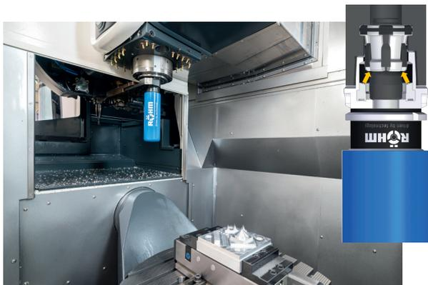
All'interno del mandrino, l'impulso di lubrificazione si attiva automaticamente. Una quantità ottimale di lubrificante Lubriflux viene spruzzata nel punto giusto del Sistema di bloccaggio dell'utensile.
