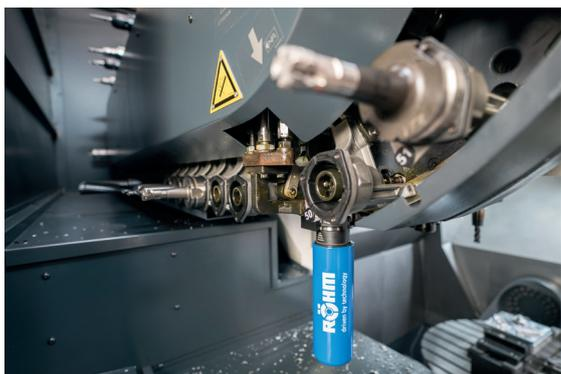
Lubritool® si trova nel magazzino utensili. Ogni volta che il controllo della macchina lo avverte che è necessario un processo di lubrificazione, Lubritool® verrà installato nel mandrino.
