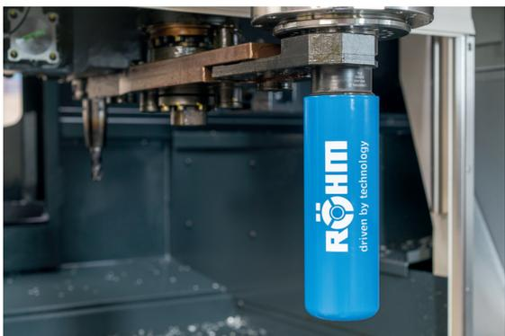
Dopo il processo di lubrificazione, Lubritool® viene riposizionato nel magazzino portautensili e rimane lì fino al successivo ciclo di lubrificazione.
