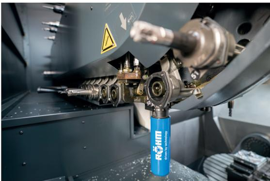
Das Lubritool® befindet sich im Werkzeugmagazin der Maschine. Sobald die Maschinensteuerung meldet, dass ein Schmiervorgang notwendig ist, wird das Lubritool® in die Spindel eingewechselt.
