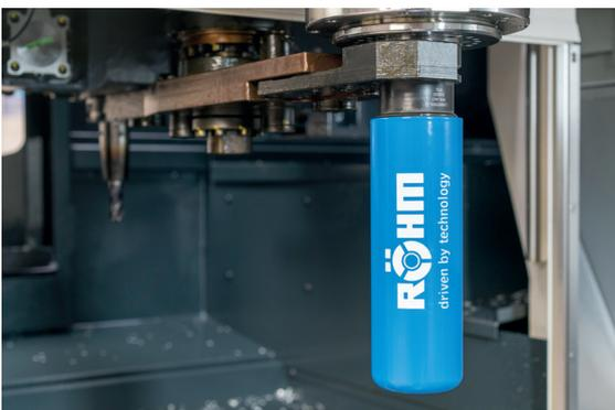
Nach dem Schmiervorgang verschwindet das Lubritool® wieder im Werkzeugmagazin und verbleibt dort bis zum nächsten Schmierzyklus.
