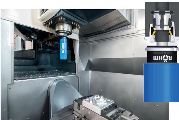
In der Spindel wird der Schmierimpuls automatisch ausgelöst. Eine optimale Menge des Lubriflux Schmiermittels wird an die richtigen Stellen des Werkzeugspannsystems gesprüht.
