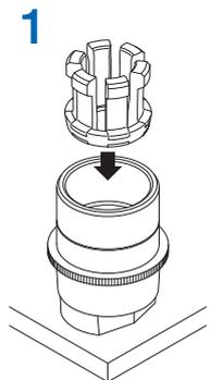
1 Segmentspannzange in Montagehilfe einlegen
