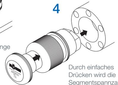
4 Durch einfaches Drücken wird die Segmentspannzange schnell und sicher in die Spindelwelle montiert
