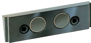
Grundbacken RNG mit Dauermagnet zur Aufnahme von schnellwechselbaren Niederzugspanneinsätzen. Zum Anschrauben an die feste und bewegliche Backe.
