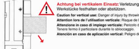
**Achtung bei vertikalem Einsatz:** Verletzungsgefahr durch Herausfallen des Werkstückes beim Lösen. Werkstücke festhalten oder abstützen.
